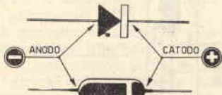
Fig. 7 - Indicazione di polarità per diodi di germanio OA85
